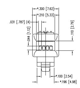
1- PLUG KIT CONSISTS OF: PRE-INSERTED PLUG HOUSING & SHIELD
